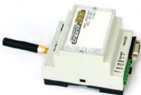
Рис. 2. Радиомодем «СПЕКТР 433» в DIN исполнении.
